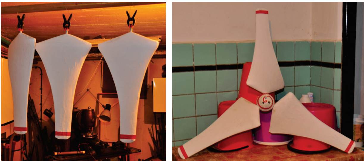
Obrázek 3.2-1: Sušení nově natřených listů při první údržbě v lednu 2012 (vlevo) a pohled na složený rotor (vpravo)
